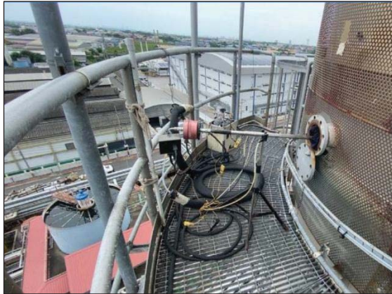
รูปที่ 3.1 การเก็บตัวอย่างคุณภาพอากาศจากแหล่งกำเนิด บริเวณปล่อง HRSG#4
