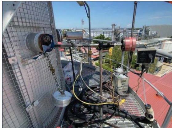
รูปที่ 3.2 การเก็บตัวอย่างคุณภาพอากาศจากแหล่งกำเนิด บริเวณปล่อง HRSG#5
