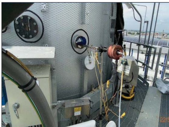
รูปที่ 3.3 การเก็บตัวอย่างคุณภาพอากาศจากแหล่งกำเนิด บริเวณปล่อง HRSG#6
